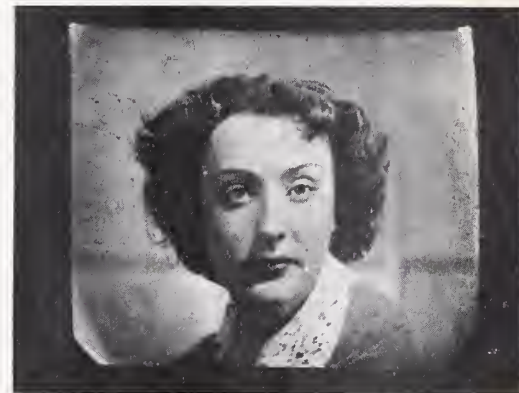
Image d'un récepteur à 819 lignes (Nouveau standard français).
